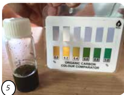
मिट्टी के रंग के आधार पर कार्बन की मात्रा जाँची।
