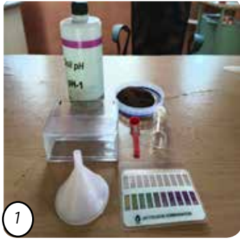
1 मिट्टी का नमूना और आवश्यक सामग्री एकत्र की। 5 मिली pH-1 घोल (सोल्यूशन) लिया।
